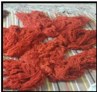
تصویر ۱۰. کلاف‌های خشک شده پس از مرحله به آب بستن (منبع: نگارنده).
